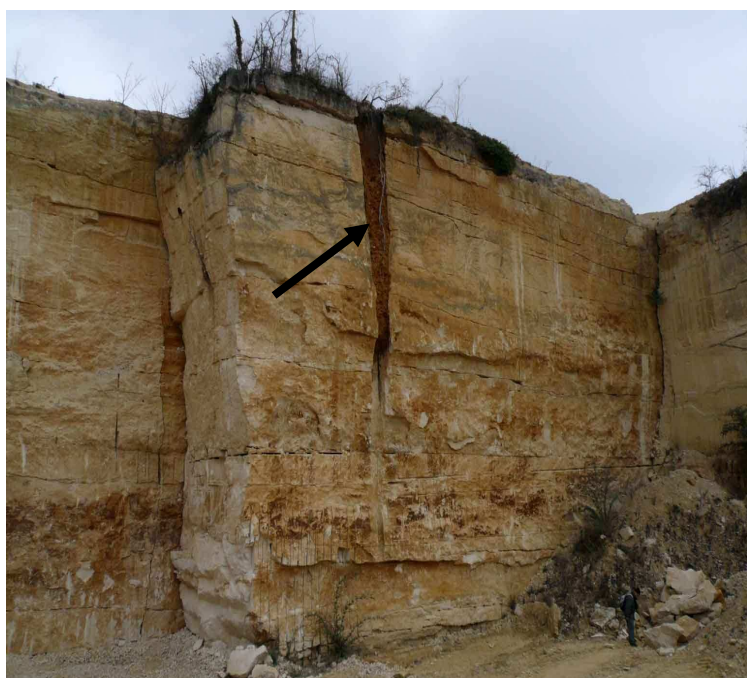
Photo 7. Une grande fracture verticale a provoqué ici l'arrêt de l'exploitation. Bien visible, l'amorce d'un puits de dissolution du calcaire autrefois empli de sables auversiens.
